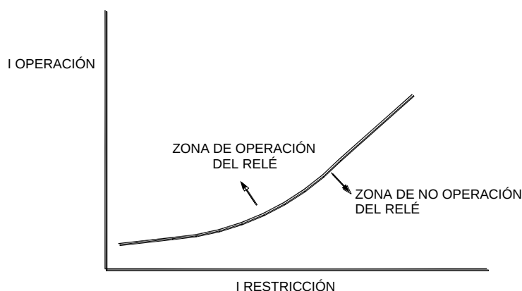
Figura 53 Característica del relé diferencial porcentual
